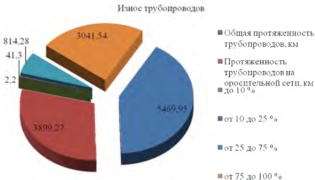
Рисунок 5.4 – Наличие и техническое состояние закрытых напорных и самотечных трубопроводов
